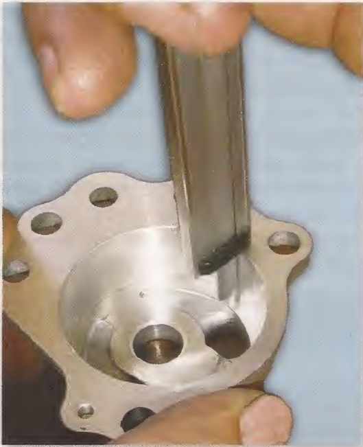
Medición de profundidad del cuerpo de la bomba
